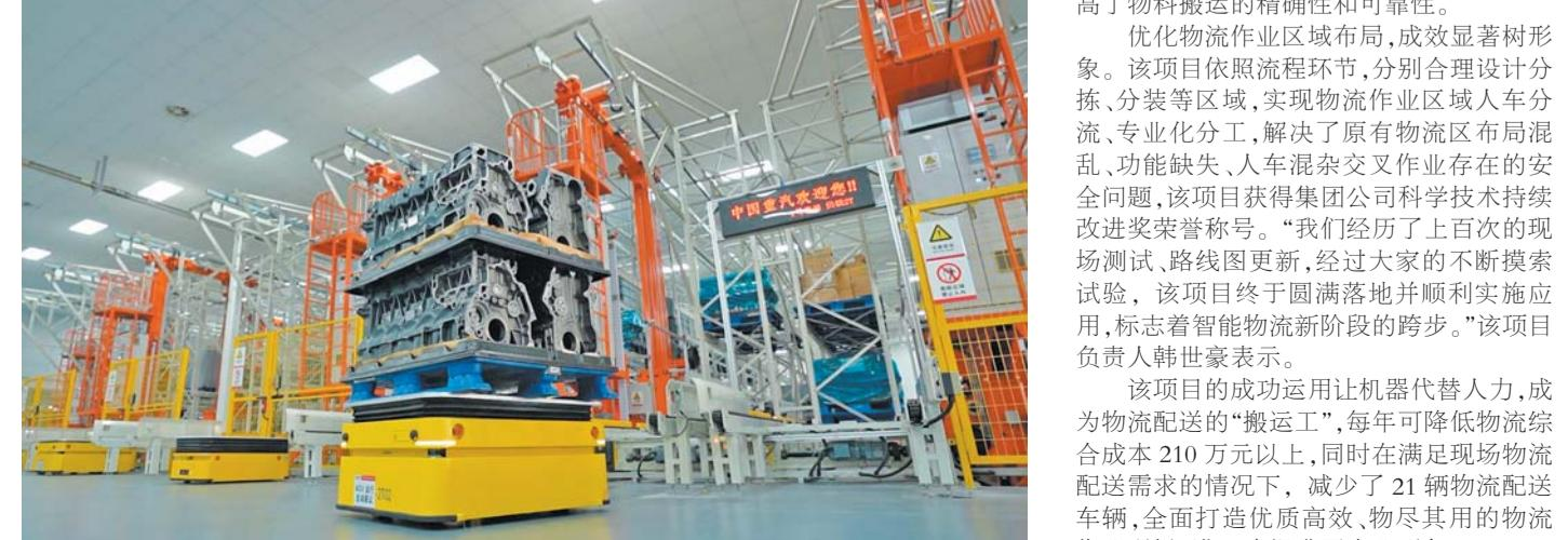
航,为物流决策提供数据支持,最终通过自主识别和搬运货物,实现物流资源的优化配置和协同作业,大大提高了生产效率,避免了人工搬运的误差和不确定性。此外,货到人拣选系统实时更新AGV任务执行状态,便于物流节点追溯及异常情况排查处理,提高了物料搬运的精确性和可靠性。
